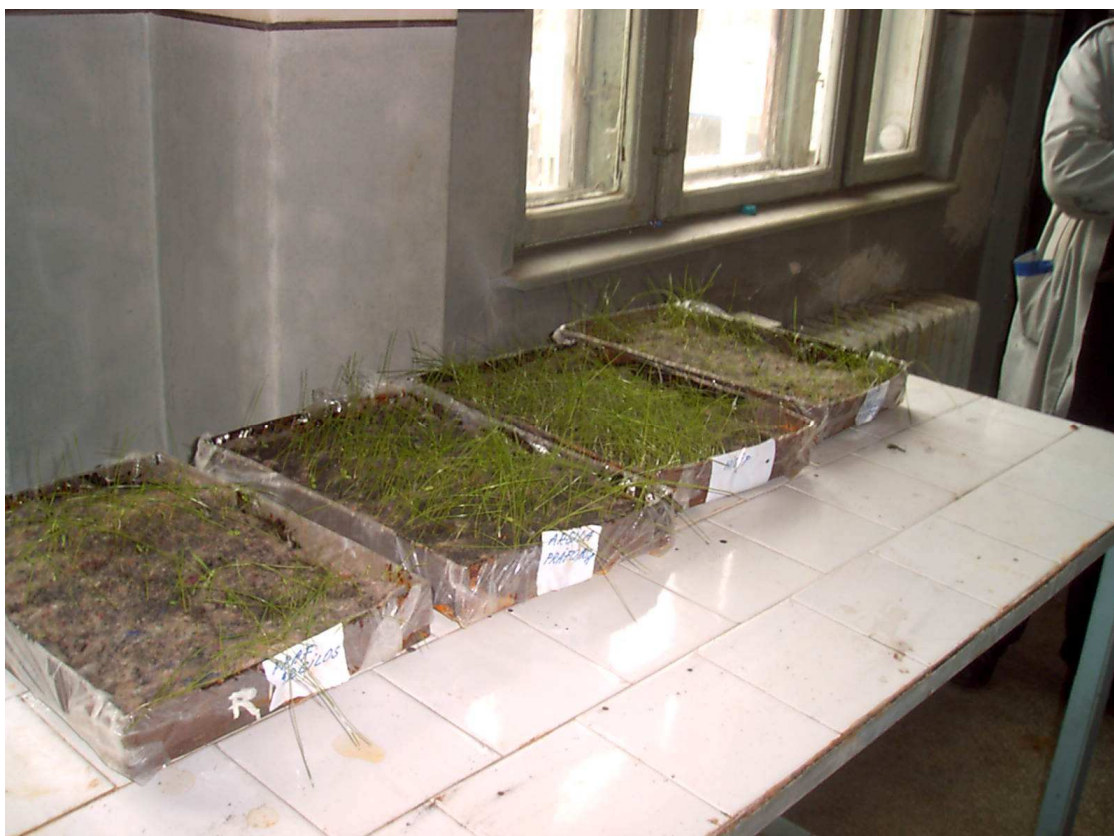
Fig.5. Geotextilul Biofelt însămânțat
